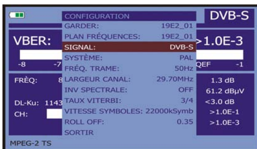
Figure 22.- Écran de configuration de mesure de signaux modulés en QPSK.
