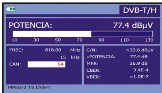
Figura 29.- Medida de la potencia de canales digitales.
