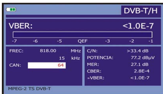
Figura 34.- Pantalla de medida del BER de señales moduladas en COFDM. VBER
