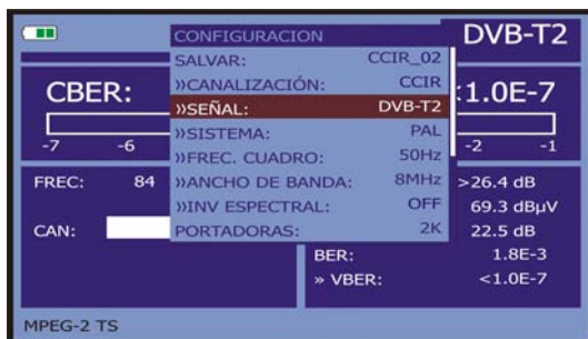
Figura 21.- Pantalla de configuración de medida de señales moduladas en COFDM.
