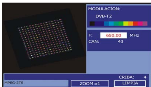
Figura 47.- Diagrama de constelación rotada. Señal DVB-T2 (QAM 256).
