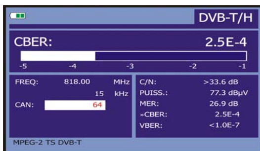
Figure 32.- Écran de mesure du CBER de signaux modulés en COFDM .
