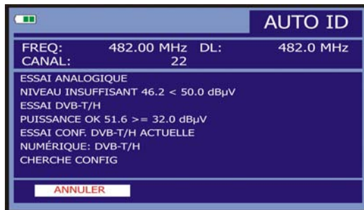
Figure 9.- Écran d'identification automatique de signaux. AUTO ID.
