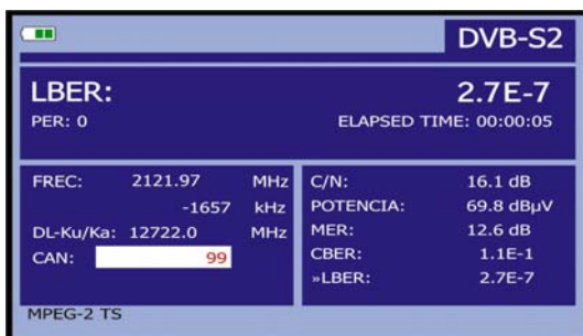
Figura 42.- Pantalla de medida del LBER de señales moduladas en QPSK/8PSK. (DVB-S2).
