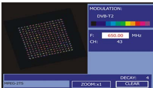
Figure 47.- Constellation Diagram. DVB-T2 (QAM 256) signal.
